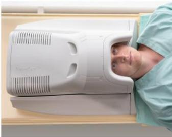
高速かつ定量的なMRイメージングは、一般的に不正確または不安定なエンコード情報によって影響を受けます。これらの影響は、画像再構成に実際の正確なエンコード情報を使用することで回避することができます。NeuroCamは、正確なエンコード情報を取得するための統合的なソリューションを提供します。画像再構成ソフトウェアskope-iと組み合わせることで、最先端のフィールドモニタリングと簡便な画像再構成のメリットを享受することができます。NeuroCamのオープンなデザインにより、被検者は快適な検査が可能で、サードパーティのモーショントラッキングやアイトラッキングソリューションを搭載することができます。これらの組み合わせにより、画期的な研究を実現することができます。
