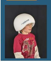
FieldLine社のHEDscanシステムは、微細加工技術により開発されたゼロ磁場光ボンピング磁力計(OPM=Optically-Pumped Magnetometer)を用いた高密度で極低温での冷却が不要な脳磁図(MEG= Magnetoencephalography )測定システムです。
