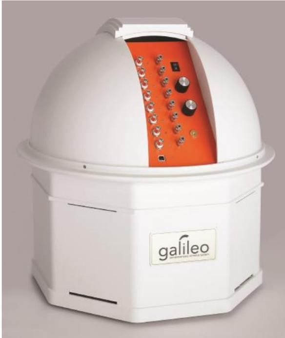
EMCI社のGalileo Tactile Stimulus Systemは世界で初めての空気圧を使用した触覚刺激装置です。非磁性のプロブを使用しており、fMRI、MEG、EEGでも使用可能です。付属ソフトウェアによって刺激のタイミング制御、連続刺激、周波数制御、刺激ランダム化およびデータ出力が可能です。またトリガー入力によってfMRIやMEGと同期した実験を行うことができます。刺激用のプロブとチューブは非磁性のシリコンまたはウレタン製です。またプロブおよびチューブは音を発生しないため実験の妨げになることはありません。NIRS、超音波、CTでの実験でも使用可能です。
