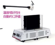
**T2CT: 複数温度選択テスト** 2つの温度帯を行き来する間の動物の位置をトラッキングし、温度嗜好性の評価が出来ます。
