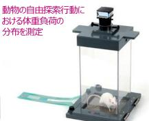
DWB: ダイナミックウェイトベアリングテスト 実験者の手技に左右されずに体重負荷/姿 勢均衡を測定出来ます(マウス/ラット用)。
