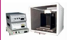
驚き・恐怖コンディショニングシステム 荷重センサーベースのフル自動システムです。
