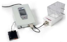
SWB: スタティックウェイトベアリングテスト 基礎的な研究手法、リモートタッチスクリーン式、 両足の体重負荷の結果を表示 出来ます(マウス/ラット用)。
