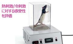
CHP: コールド/ホットプレート 一定温度もしくは温度傾斜での評価 が出来ます。 熱刺激のみならず、 冷刺激にも対応しています。
