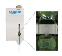
AcouTrapは、粒子、細胞、または細胞外小胞体を流体の流れに逆らって捕捉・保持する音響定在波を使用したトラッピングユニットです。
