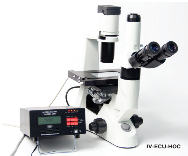
STEVのステージ上の環境はINV-101ステージとなり、ECUコントローラがチャンパー内の温度を維持します。
