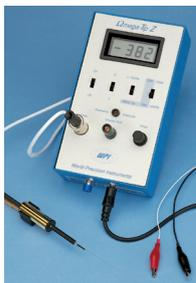
金メッキされた小型プローブは電解液中で微小電極のインピーダンスがモニタできます。また電極先端部のクリーニング機能により、蓄積した不純物などが素早く取り除けます。**オメガチップZ**は最大2000mVまでの電極先端電位が測定できます。電池の連続使用時間は数百時間です。
