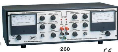
モデル260は電氣的にアイソレーションされた電池駆動式のデュアルチャンネルのイオンフォレーシスで、マイクロピペットから色素、薬液やイオン化充填物質などの微量注入が行えます。一般的な使用法は、定電流電源装置として2チャンネルを同時使用して各チャンネルから異なった定電流を供給します。この使用法では、片方はマイクロピペット内から外部への溶液の拡散を防止(保持電流)するため、もう片方は、イオン化充填物質の駆出に用います。先端がサブミクロンのマイクロピペットを使用した場合、マイクロピペット内から外部への溶液の拡散が殆ど生じませんので、上述のような保持電流は不要となります。モデル260は1チャンネル当たり2本の9Vアルカリ電池を使用しています(合計で4本)。本装置は、トランスを使用しない独自の回路で±9Vを±100Vに変換しています。
